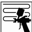
Appliquer une couche pleine sur la zone de raccord en dépassant légèrement sur la surface P3000.
